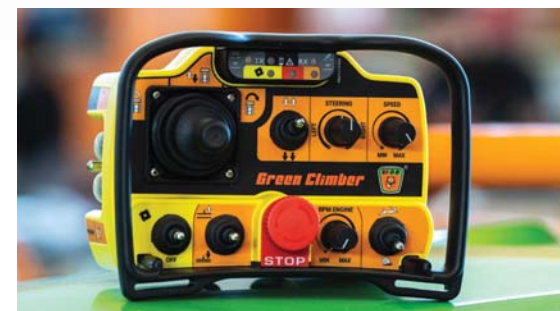
LA GUIDA È ESTREMAMENTE FACILE E PRECISA DATO CHE AVANZAMENTO E STERZATA DEI CINGOLI AVVENGONO ATTRAVERSO UN UNICO JOYSTICK, LASCIANDO A DISPOSIZIONE L'ALTRA MANO PER TUTTE LE ALTRE FUNZIONI DEL RADIOCOMANDO.
